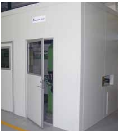
Inkapsling och ljuddämpning maskin Eden Europé s.r.o, Adamov, Tjeckien.
